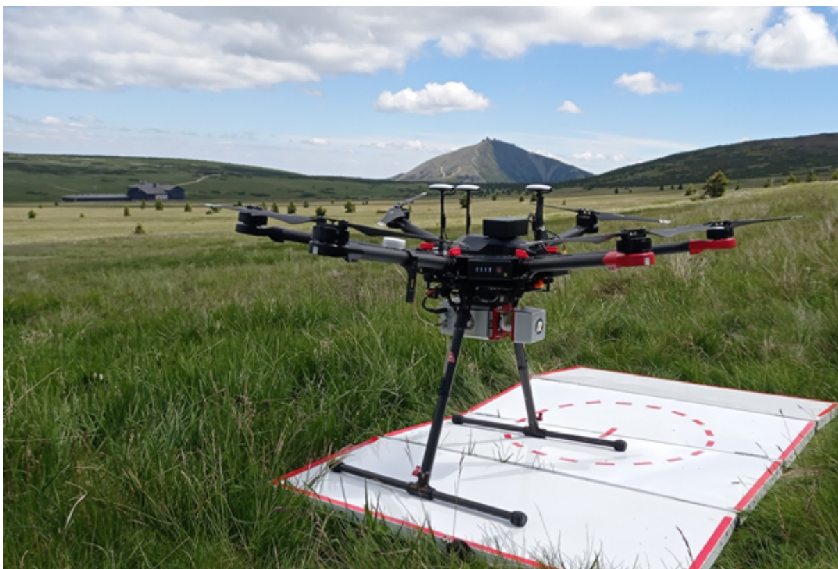
Multikoptéra DJI M600 s laserovým skenerem Riegl MiniVUX před skenováním vegetace v KRNPu (UpVision)
