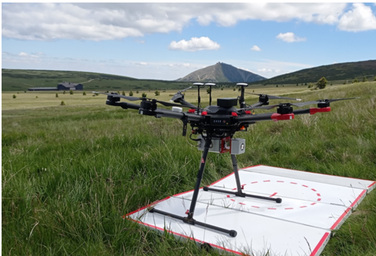
Multikoptéra DJI M600 s laserovým skenerem Riegl MiniVUX před skenováním vegetace v KRNAPu (UpVision)
